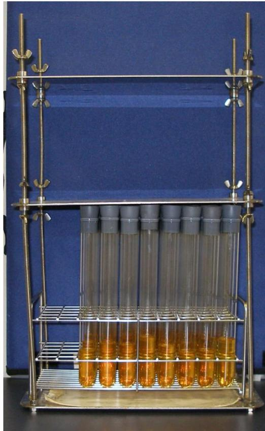
写真 1 ステンレス製ブチルゴム栓押さえ (特注品)
