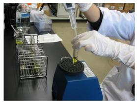
図1 炭酸ナトリウム溶液を添加する操作
