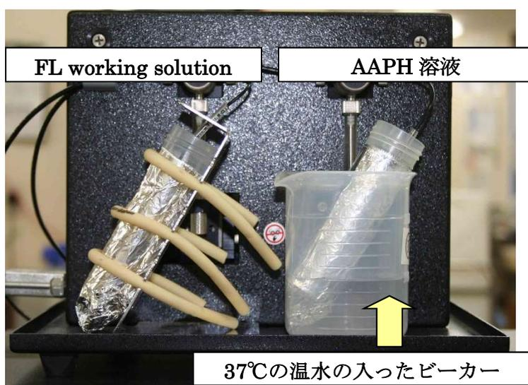
図 3 自動分注装置への AAPH 溶液の取り付け例
