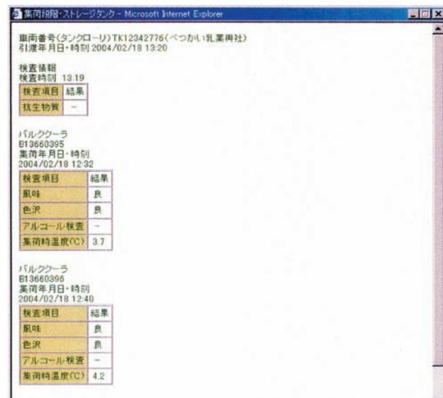
加工段階では、ストレージタンク（貯乳タンク）、サーボタンク、充填ラインの温度記録が閲覧できる。
